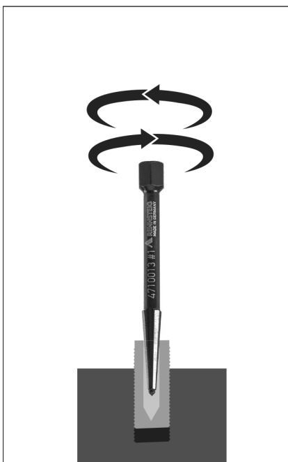
Vastzittende schroef losmaken en losdraaien met geschikt gereedschap
